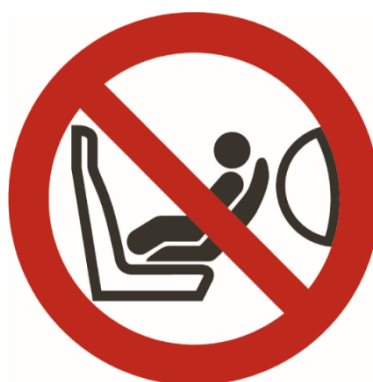
Σχήμα Β Εικονογράμμα σύμφωνα με το πρότυπο ISO 2575:2004 - Z.01 το οποίο πρέπει να χρησιμοποιείται και έχει εξωτερική διάμετρο τουλάχιστον 38 mm για τους κανονισμούς αρ. 44 της ΟΕΕ/ΗΕ (44R03) και αρ. 129 της ΟΕΕ/ΗΕ.
